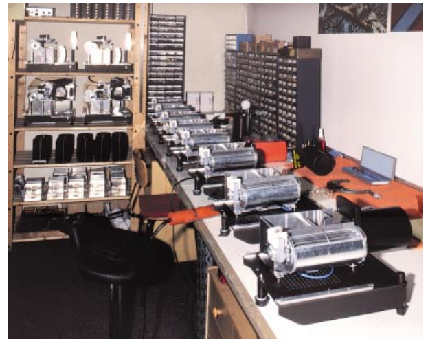
Serienfertigung in der Diaprojektoren-Manufaktur. Die in Kleinserien gebauten Projektoren werden komplett in München gefertigt.
